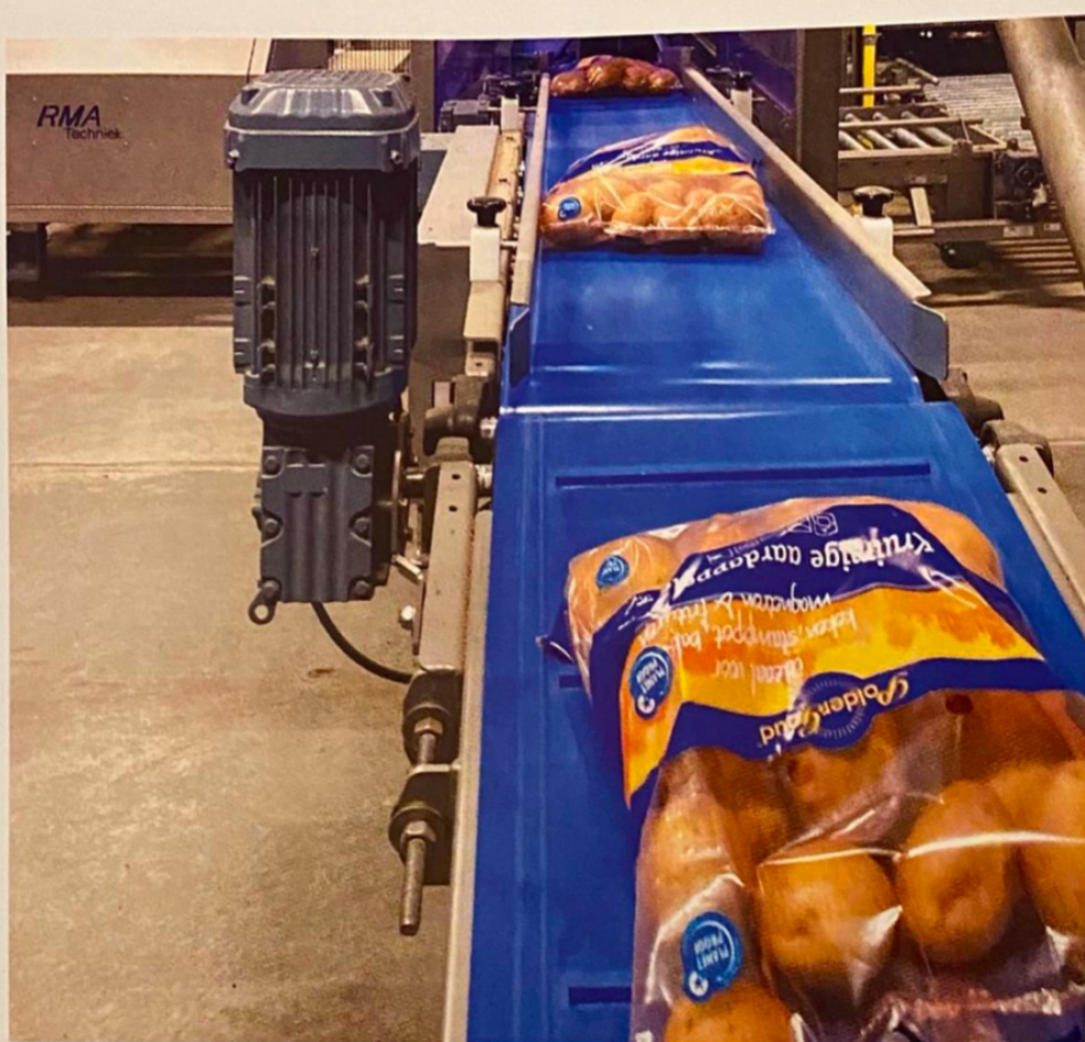
Zakproducten van 2,5 t/m 5 kg worden automatisch in een krat gelegd met een max van 20 kg per krat
