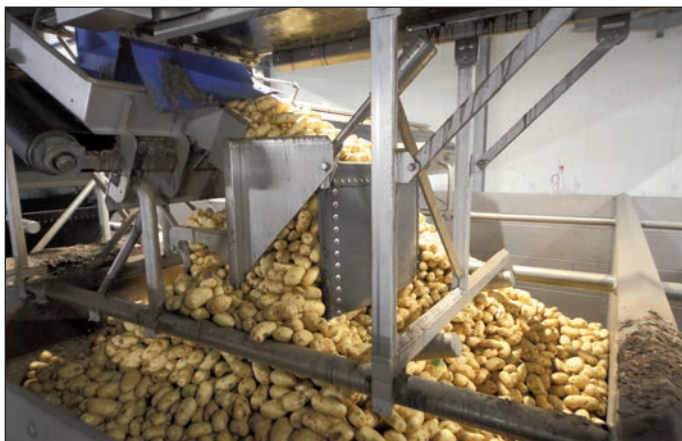
Foto 5 Lamb Weston / Meijer heeft voor groot aantal tussenbunkers gekozen om zowel nauwkeurig als flexibel de productielijnen van het juiste product te kunnen voorzien.
