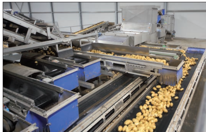
De allerbelangrijkste meting van die optische sorteerder is die van de knollengte.
