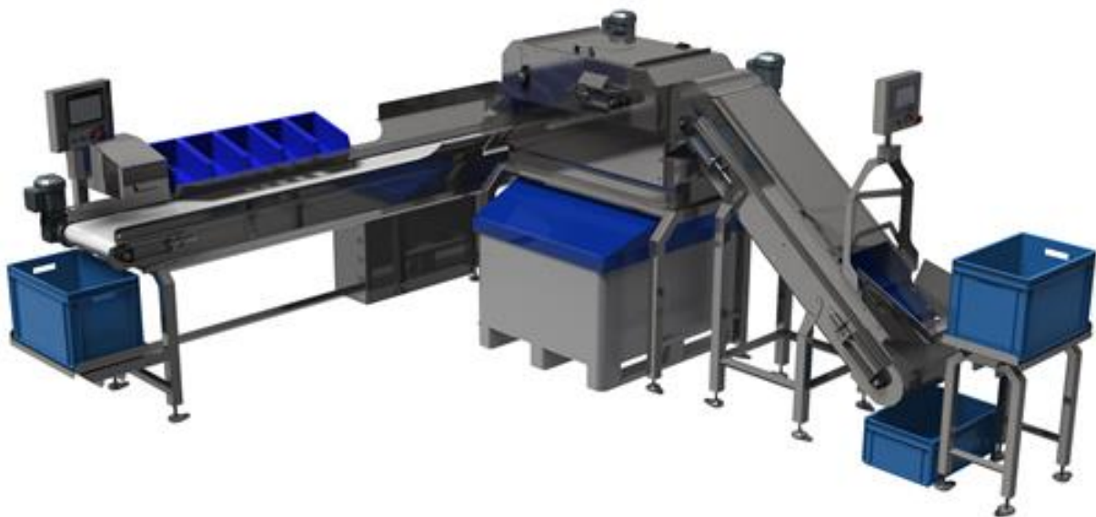
Uientarreeerlijn van RMA-techniek met afstaarter en sorteertafel
